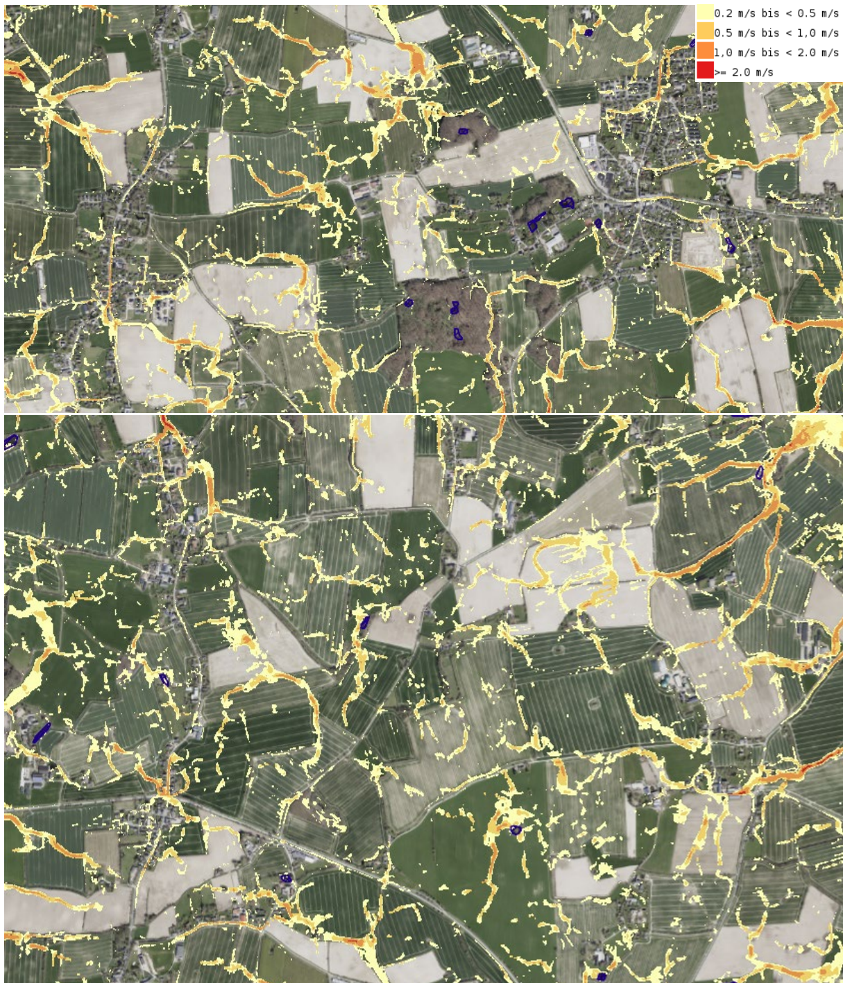
Abbildung 21: Fließgeschwindigkeiten im Quartier (oben: Steinbergkirche und Großquern, unten: Kalleby, Nübel, Nübelfeld und Gintoft) (Quelle: 'WMS Hinweiskarte Starkregengefahren (HWK_SRG)', 2024)
