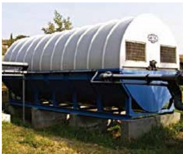
Abb. 2: Oberirdisch aufgestellter Rotationstauchkörper (Quelle: MITA Water Technologies)
