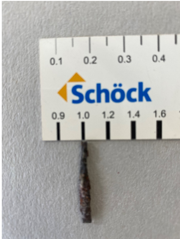
Bild 5 – Drahtanker – geschwächter Querschnitt 1,0 mm
