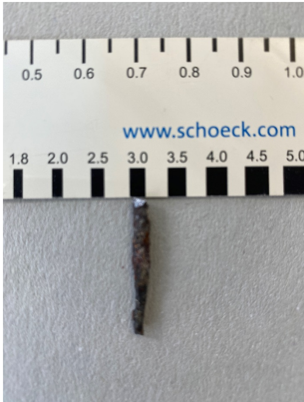
Bild 4 – Drahtanker - ungeschwächter Querschnitt 3 mm
